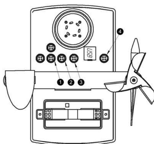
Рисунок 3 — Расположение разъемов на нижней панели станции «СОКОЛ-М1»
