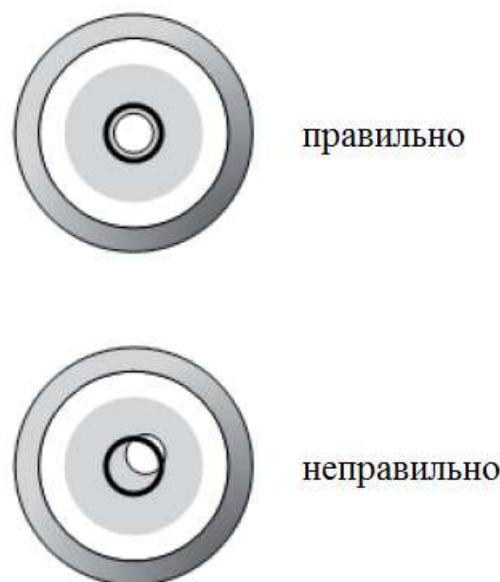
Рисунок 2 — Контроль наклона основания с помощью пузырькового уровня
